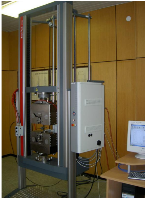
Slika 7. Kompjuterizovani merni sistem Zwick/Roell Z 100
